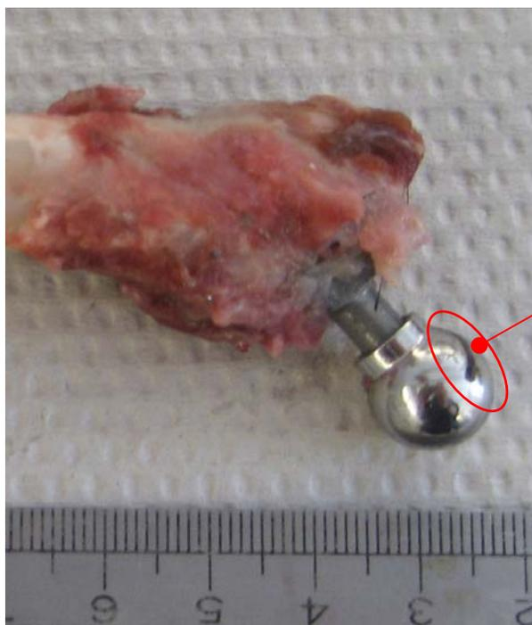
Beschädigung des Implantates durch oszillierende Säge bei Entnahme
