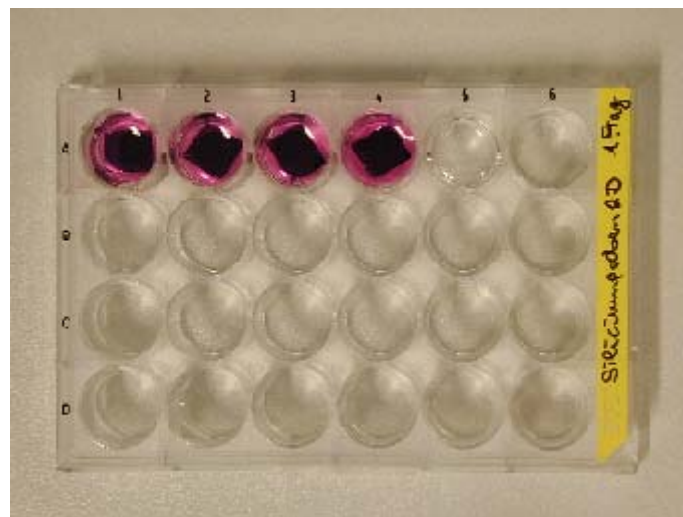
Abbildung 2: 24er Kulturwell mit Siliziumwafern und Nährmedium MM1
