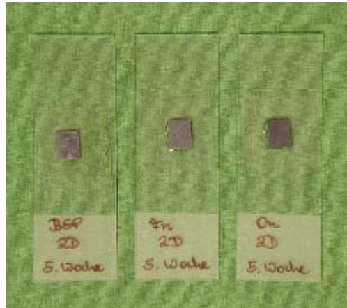
Abbildung 5: gemountete Siliziumwafer auf Objektträgern, vorbereitet zur fluoreszenzmikroskopischen Analyse
