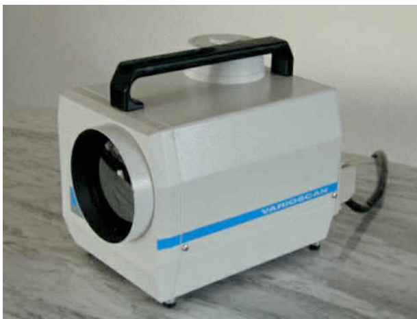
Abbildung 17: Varioscan LW3011 Wärmebildkamera mit Stickstoffkühlung.
