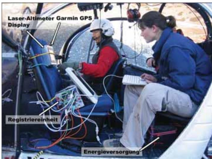
**Abbildung 3.7:** Aufbau der Registrierapparatur des BGR-P30-Systems in der Helikopterkabine. Bild aufgenommen von N. Blindow (BGR) am 28.02.2008 in Zermatt (Schweiz).
