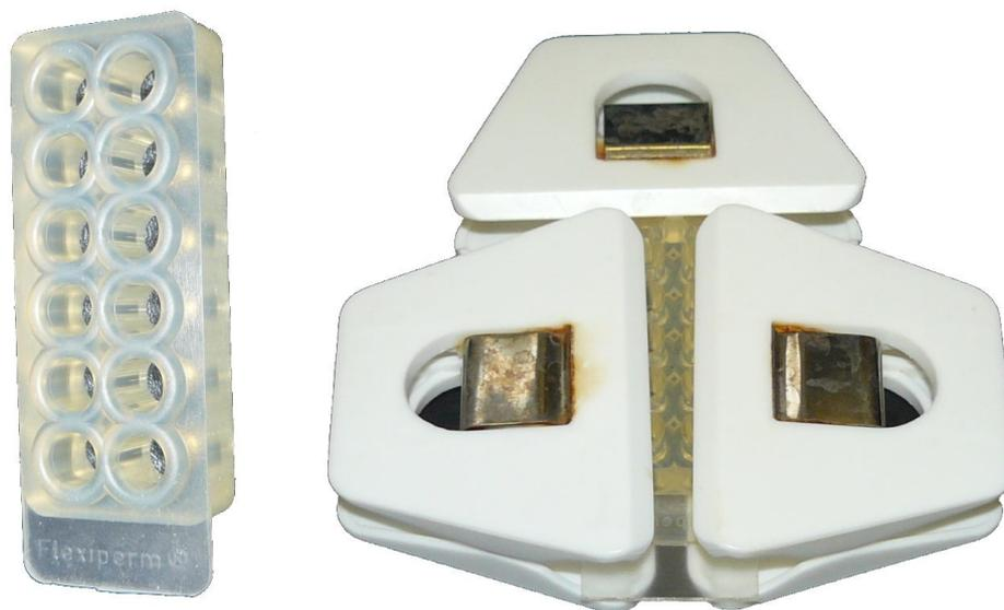
**Abbildung 7:** Die verwendete Flexiperm® Inkubationskammer (links) und das zusammengebaute Inkubationssystem aus dem bespottetem Slide und der mit drei Klammern befestigten Inkubationskammer (rechts)
