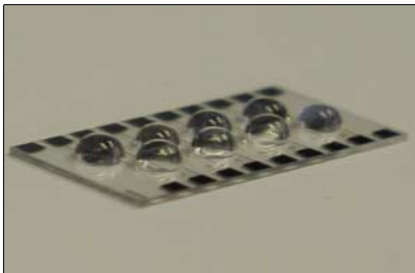
Abbildung 5-33: Ansicht eines strukturiert silanisierten Transducers, auf dem über den 8 Interdigitalstrukturen Wassertropfen aufgebracht wurden. Die hydrophobe Oberfläche außerhalb des Benetzungsbereiches der Tropfen verhindert ein Verlaufen.
