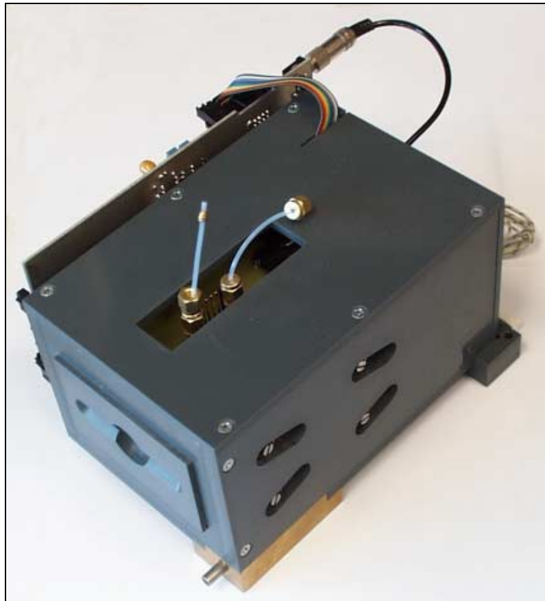
Abbildung 4-13: Foto vom Einschubmodul mit seitlich angebrachter Messwerterfassungsplatine.
