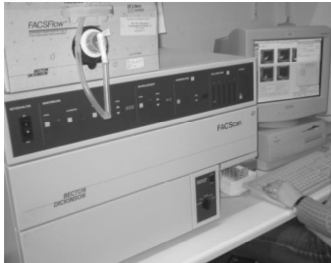
**Abb. 2.6.** Arbeitsplatz am Durchflusszytometer mit computergestützter Steuerung und Auswertung.
