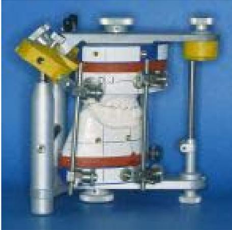
Abbildung 14: Modelle mit angebrachten Fixations- und Positionierungselemente in eindeutiger Operationsposition im Artikulator
