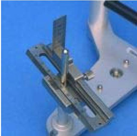
Abbildung 10: Aufschieben der Messwertübertragungslehre auf den Stützstift
