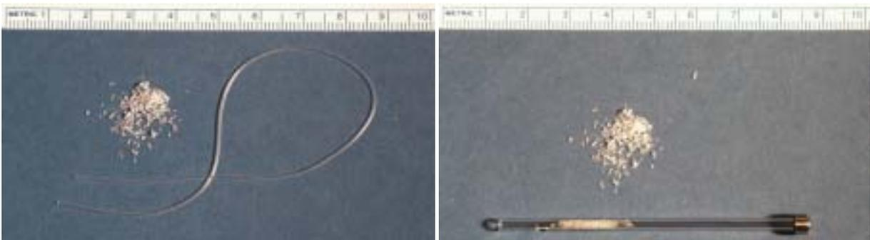
Abbildung 12: Links: Photo des Medizin-Schlauchs und des gekörnten PDMS-Materials nach Mörsern des Schlauchs; Rechts: fertig gefüllter Liner
