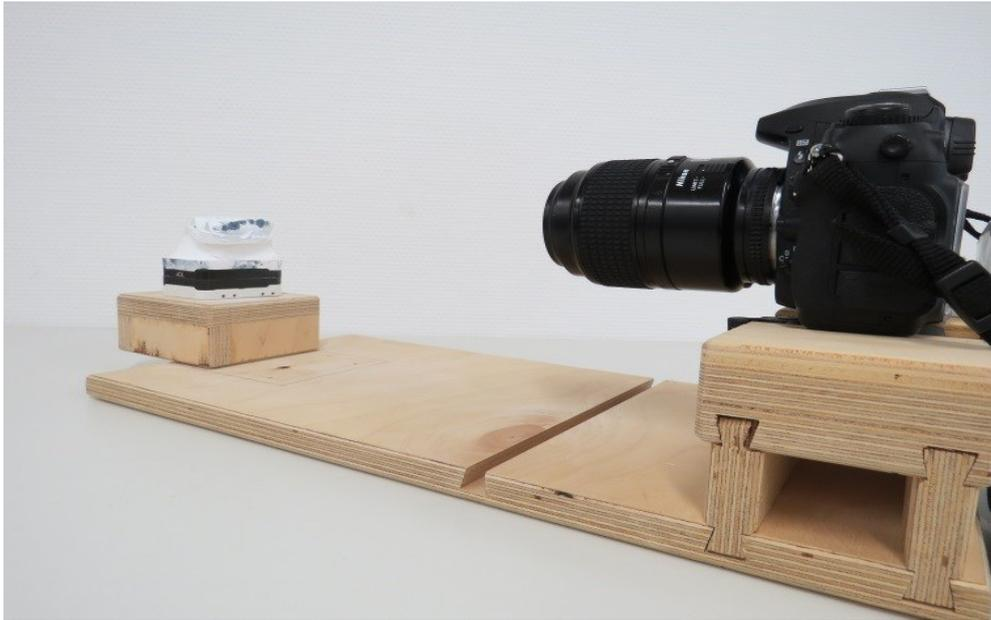
**Abbildung 9: Das geputzte Modell ist über ein Magnetsystem auf der Holzplatte fixiert, die Kamera rastet über einen Klickmechanismus ein. So wird gewährleistet, dass die Fotos immer im selben Winkel und derselben Perspektive aufgenommen werden.**
