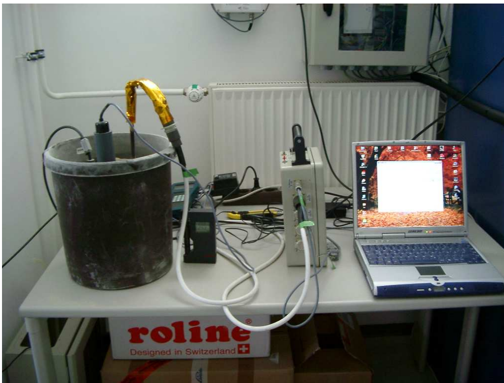
Abbildung 5.15: Messaufbau mit der Probe mit Thermalsonde und Feuchtesensoren (links im Bild), der Elektronik (Mitte) und dem Laptop zur Steuerung der Messung (rechts im Bild).
