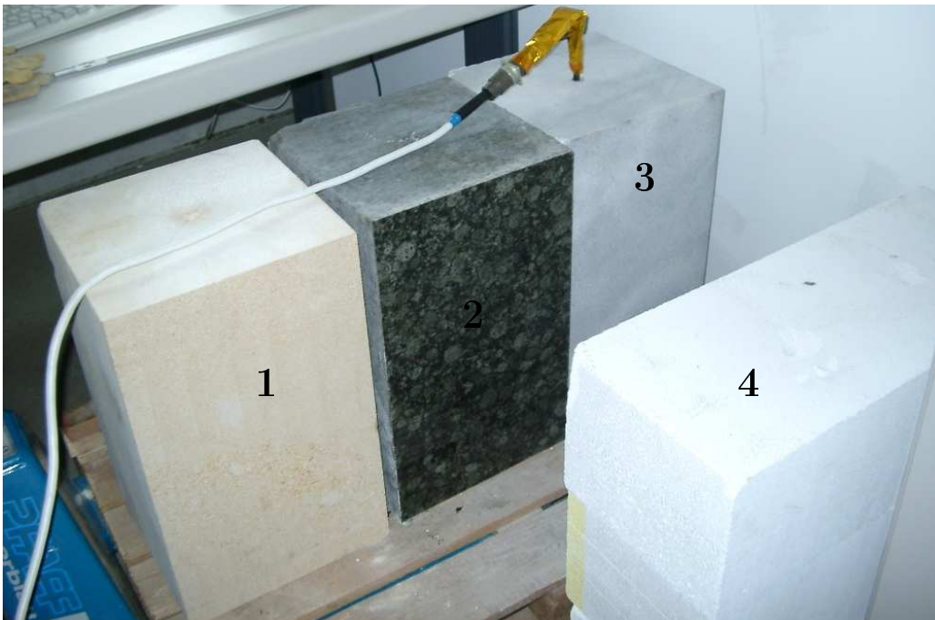
Abbildung 5.27: Messaufbau zur Bestimmung der Wärmeleitfähigkeit von Gesteinen. Von links nach rechts: Sandstein (1), Marmor (2), Granit (3). Vorne rechts im Bild: Ytong™(4).
