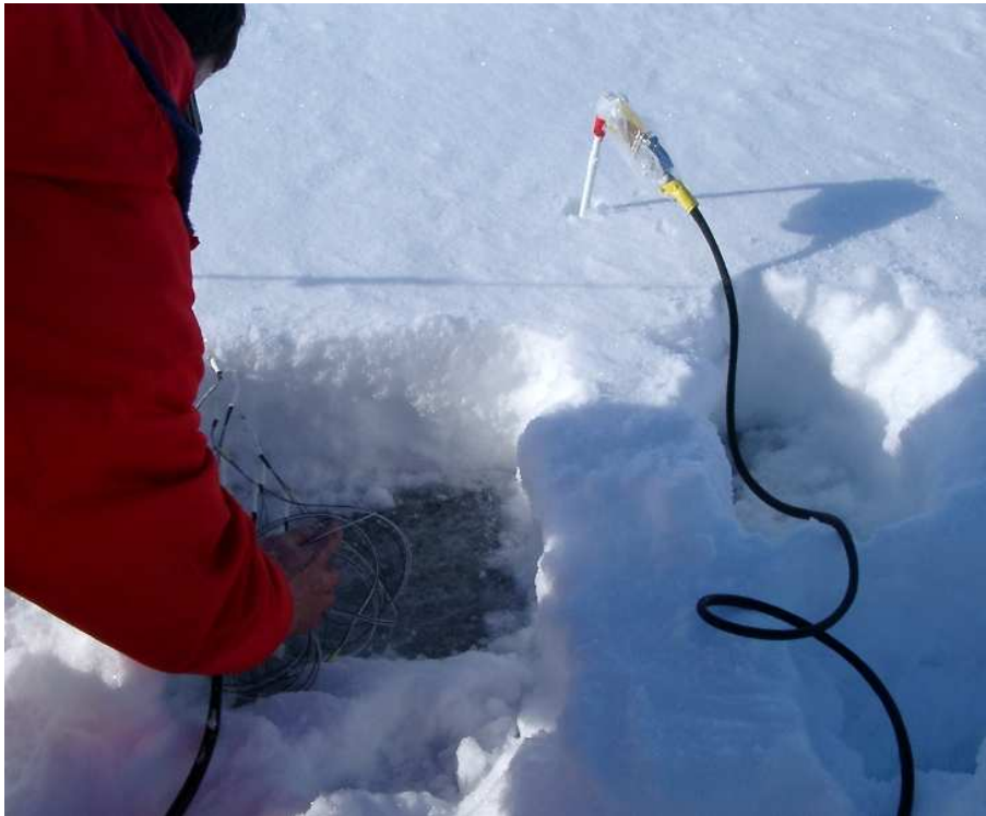
Abbildung 4.16: Installation der Temperatursensoren. Links im Bild die PT1000, rechts die EXTASE-Thermalsonde (die Sonde wurde nach Aufnahme dieses Fotos noch umgesetzt).
