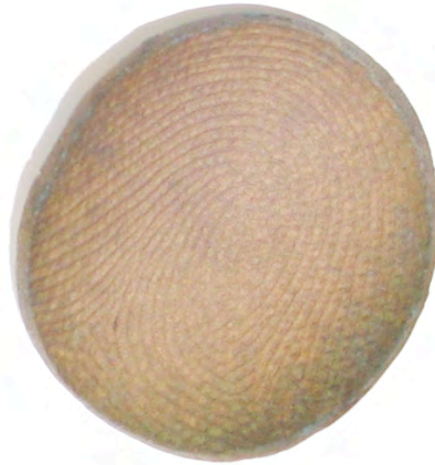
Abbildung 11: Kreisrund ausgestanzte Abformung, mit Gold bedampft.
