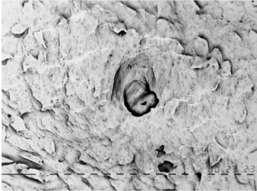
Abbildung 7: Darstellung einer einzelnen Schweißpore (REM 160fach) in einer Silikonabformung als „Zapfen“.
