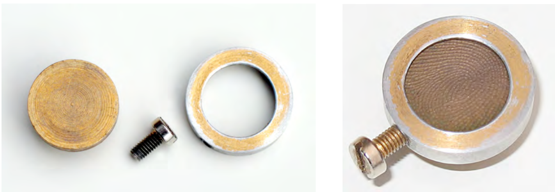
Abbildung 16: Die endgültige Fassung für die Silikonabformungen.
