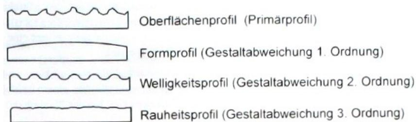
Abb. 12: Überlagerung von Abweichungen an einem Oberflächenprofil [46]
