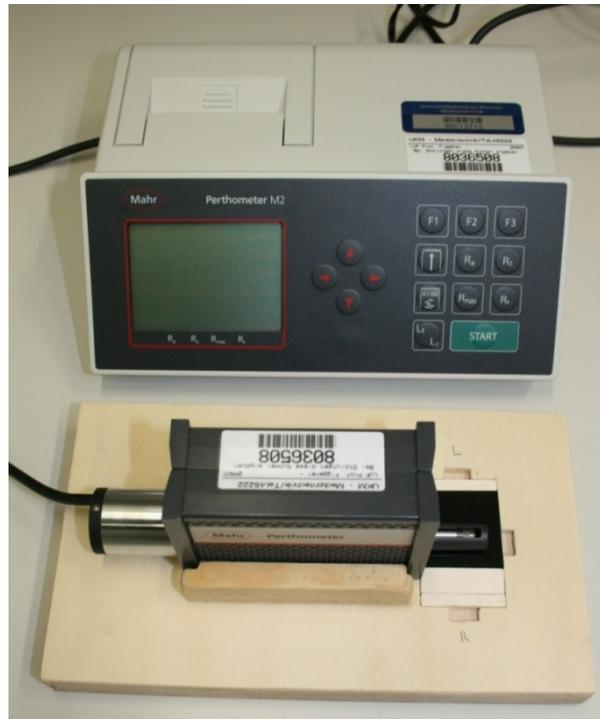
Abb. 35: Messung mit Perthometer und der Prüfkörperhalterung
