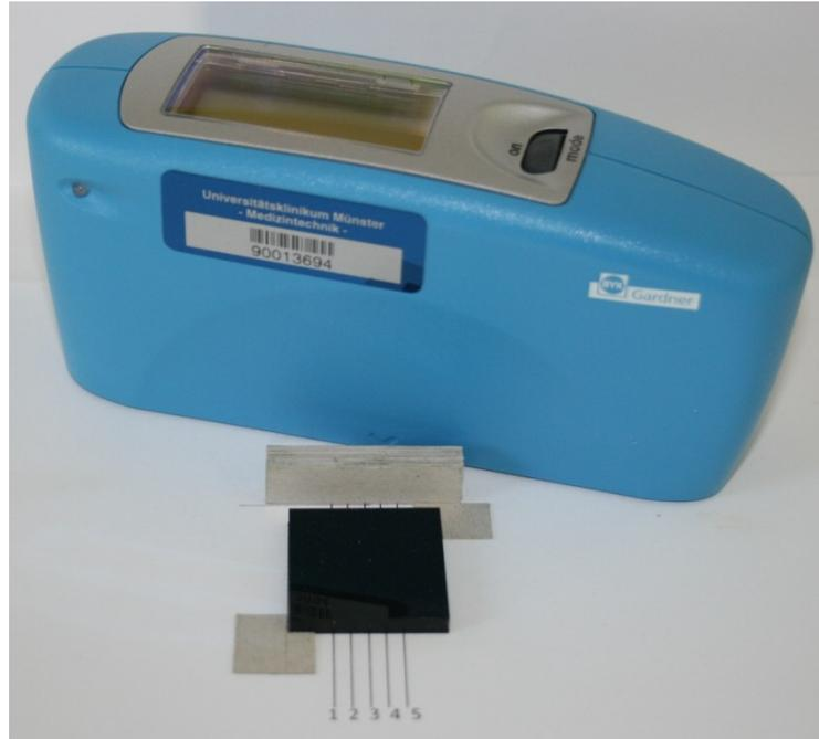
Abb. 34: Glanzmessung mit dem mikro-TRI-gloss-Gerät
