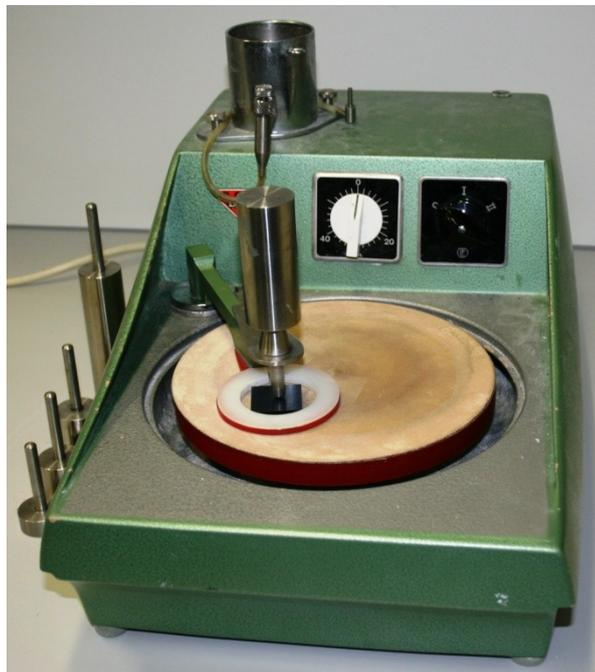
Abb. 24: Scan Dia Scandimatic mit Probekörper und Auflagegewicht
