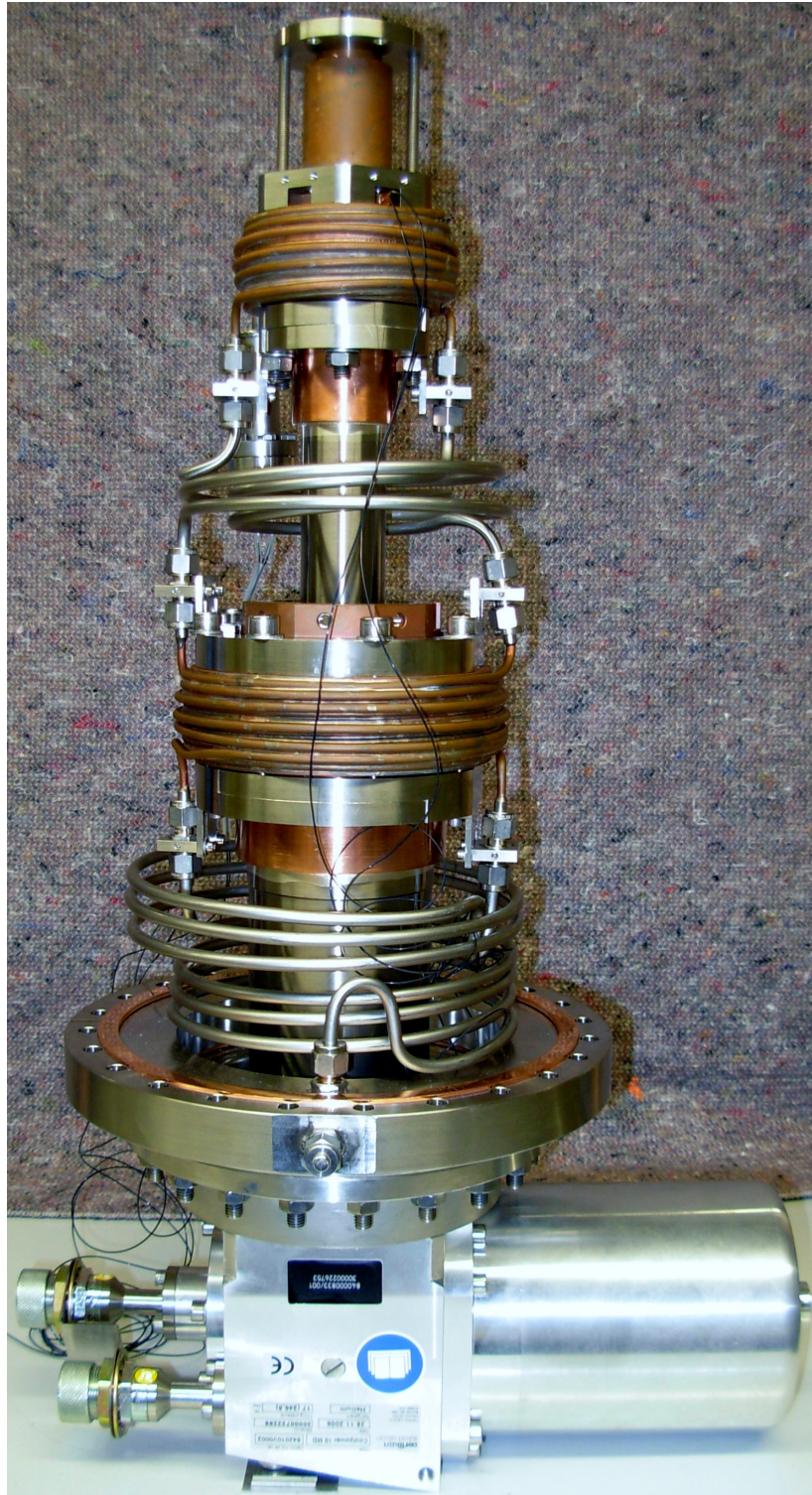
Abbildung 5.1.8.: Photo des Kaltkopfs mit montiertem Gaskühlungssystem. Die kalte Stufe befindet sich am oberen Ende des Bildes, die warme Stufe in der Mitte und der Antrieb des Kaltkopfs am unteren Bildende. Die sichtbaren Kabel versorgen einerseits die Temperaturdiode und andererseits die Heizung der kalten Stufe. (Photo: A. Khoukaz)
