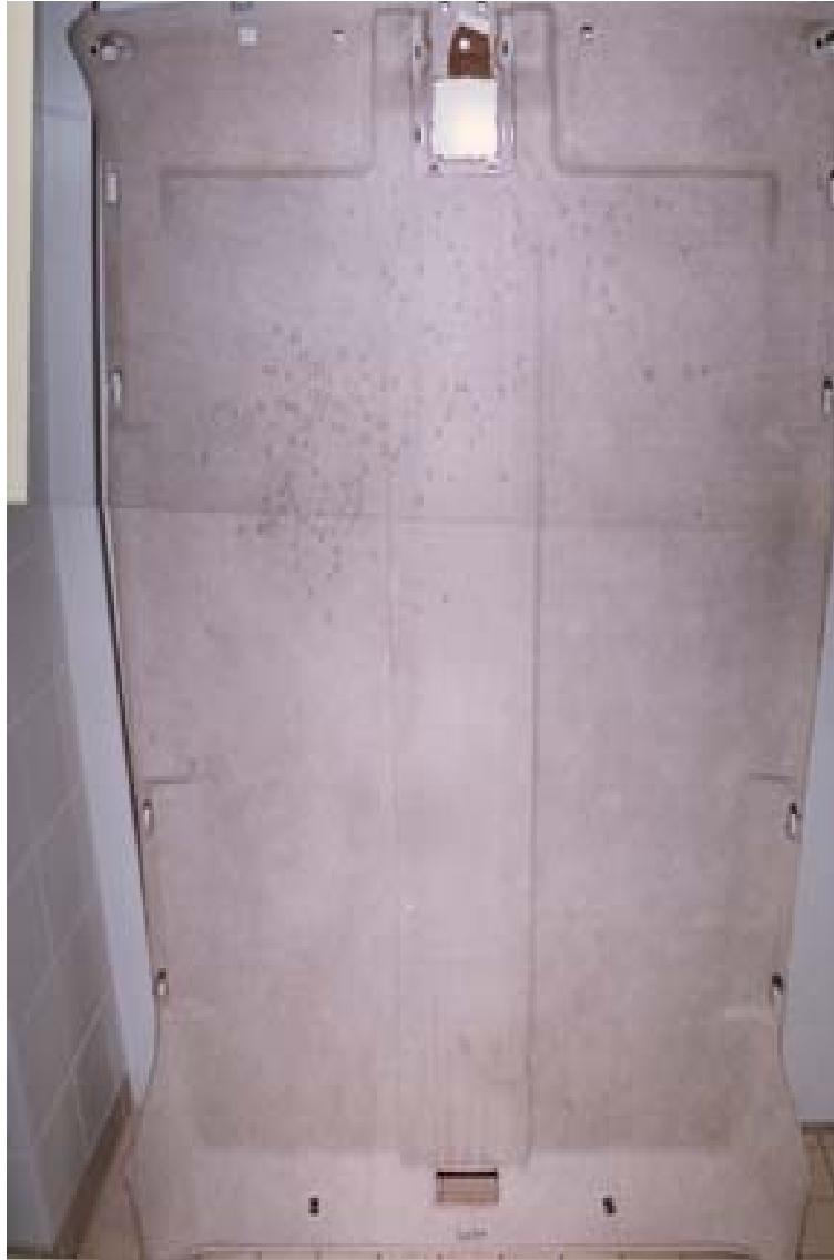
Abb. 57, ausgebauter Dachhimmel des Fahrzeugs mit markierten Spuren
