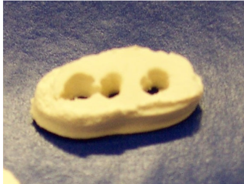
Abb. 2.11. Individuelles Doppelsinterimplantat mit eingefrästen Kanälen. Die Wände der Kanäle sind unregelmäßig und rau. Zustand vor der Bearbeitung der Außenflächen.
