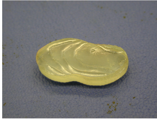
Abb. 2.1. Das Stereolithographiemodell. Die Terrassen auf der Oberfläche interpolieren schräge Flächen und dienen als Marker für die Präzision.
