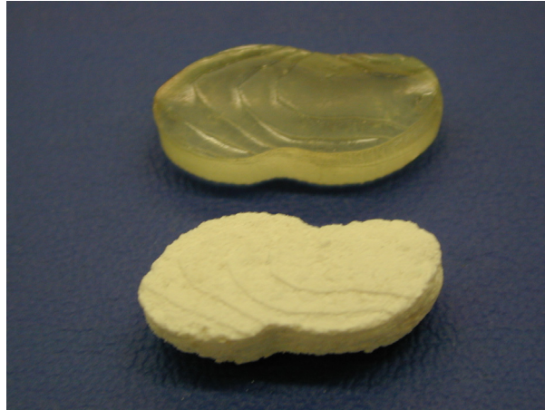
Abb. 3.2.2. Individueller Pressling aus Doppelsintercopolymer, darüber das Stereolithographiemodell. Der Pressling entspricht in seinen Abmessungen exakt dem Originalmodell (Länge der Presslinge jeweils 2,2 cm, Maßstab ca. 2:1). Auffällig sind die feine Zeichnung der Terrassen sowie die grobe Körnung des Presslings.
