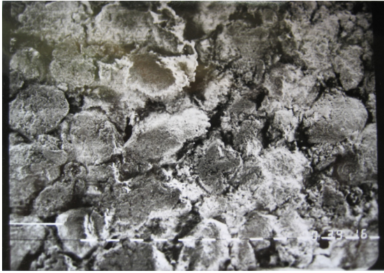
Abb. 3.26. Das Doppelsintercopolymer: Rasterelektronenmikroskopische Aufnahme. Man beachte die Mikroporosität der Partikel. Ein weißer Abschnitt der schwarz-weißen Linie im Bild entspricht 100 \mu\text{m} .
