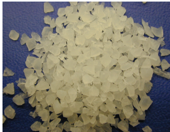
Abb. 1.2.2. PLA-PGA-Copolymer mit einem PLA-Anteil ausschließlich aus L-Milchsäure (Poly(L-lactid-co-glycolid))
