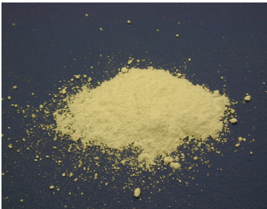
Abb. 1.2.1. PLA-PGA-Copolymer mit einem PLA-Anteil aus L- und D-Milchsäure (Poly(DL-lactid-co-glycolid))
