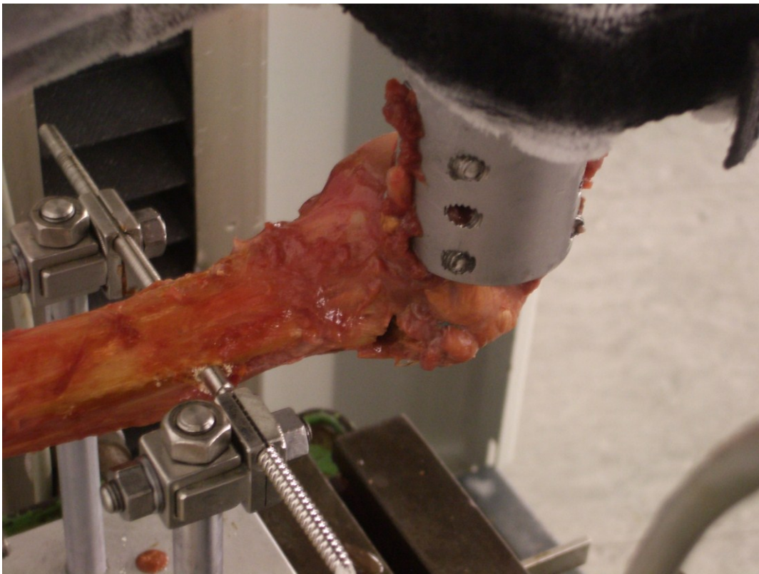
Abb. 10: Fixierung des Muskelbauchs an der Kryo-Klemme. Die Position ist in physiologischer Zugrichtung ausgerichtet (0° Abduktion in neutraler Position). Angebrachte rostfreie 5mm Stahldrähte verhindern eine Rotation des Humerus.
